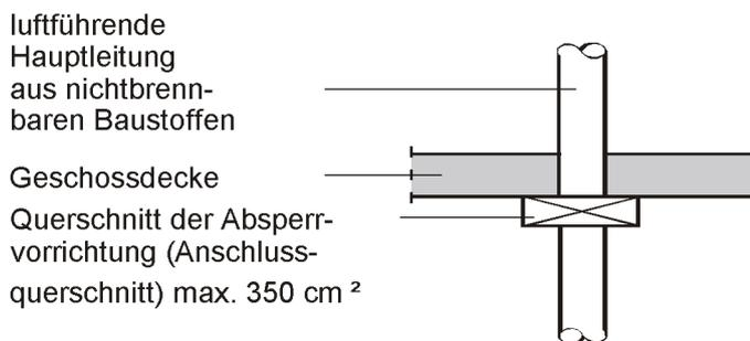
6.3 Schachtlösung für Lüftungsanlagen nach DIN 18017-3: 2009-09
