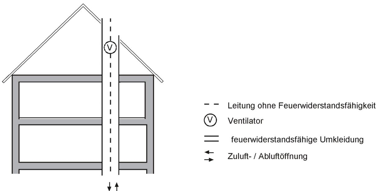
**3 Leitungsführung durch raumabschließende Wände notwendiger Flure, an die Anforderungen hinsichtlich der Feuerwiderstandsfähigkeit gestellt werden**
