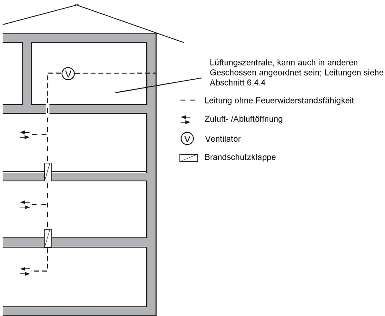
**Bild 1.2: Schachtlösung**
