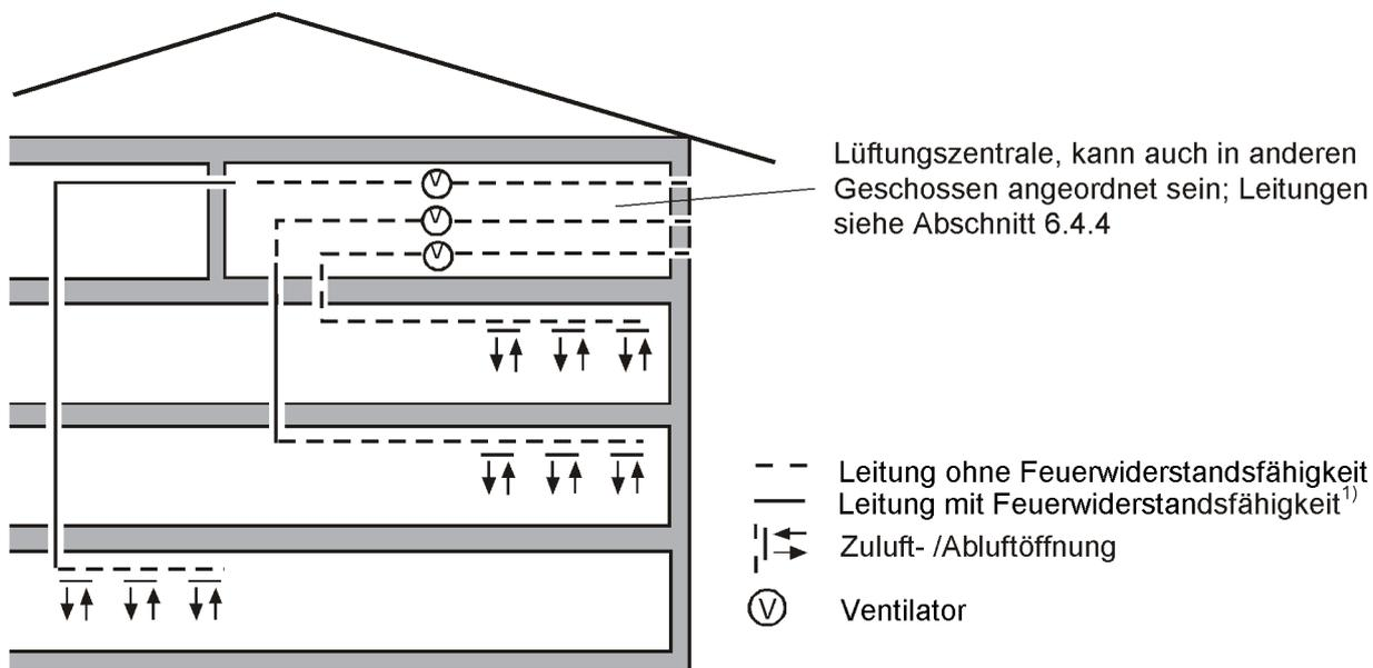
1) Die Feuerwiderstandsfähigkeit der Leitungen muss auch in den Durchdringungen der Decken oder Wände gegeben sein.
