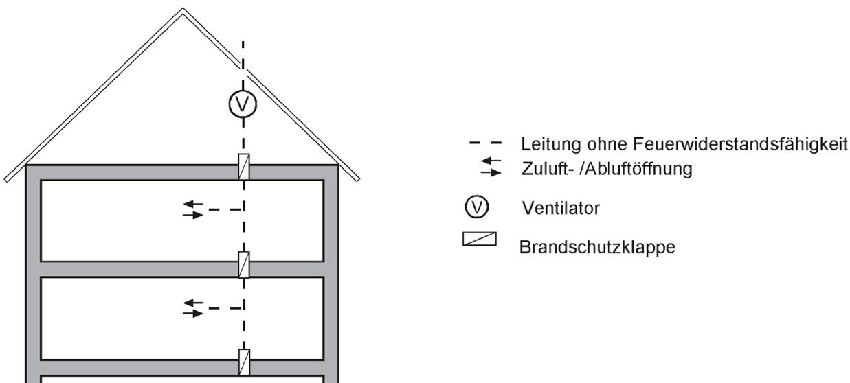
**Bild 2.2: Schachtlösung**
