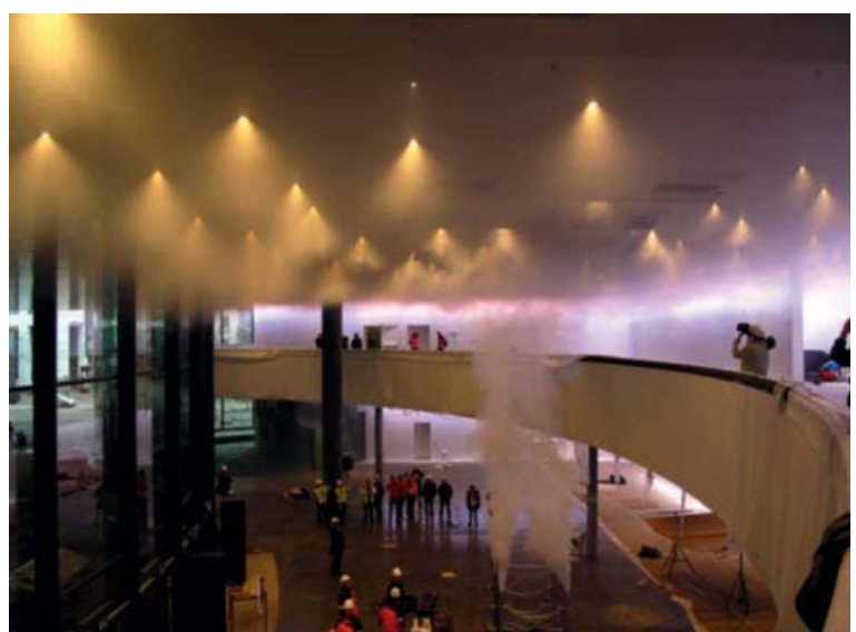
Abb. 1: Wirksamer Rauchabzug als Ergebnis des bestimmungsgemäßen Zusammenwirkens
